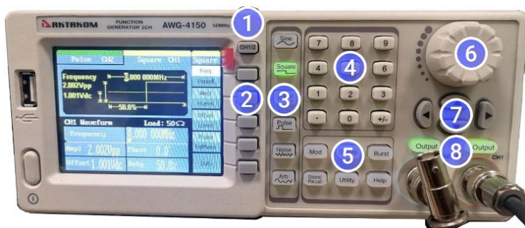
Рис. 3.4 Элементы управления генератором AWG-4150
