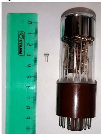
Рис. 1.1 Габаритное сравнение стандартного SiPM (слева) и классического ФЭУ (справа)
