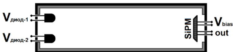
Рис. 3.2 Элементы светоизолированной камеры с SiPM и ее схематическое изображение
